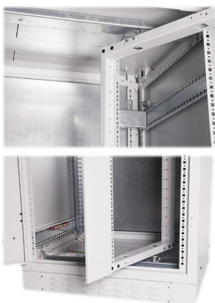
A inclusão de estruturas pivotantes (40U ou 45U) e (19” ou 21”) no armário, possibilita a instalação em rack e o acesso total e fácil aos equipamentos até uma carga máxima de 150kg. Sendo uma estrutura móvel, permite o acesso totalmente desimpedido a outras zonas interiores do armário.
